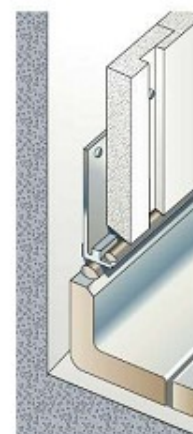
Рис.10. Край с базовым профилем во влажной зоне и кромка плитки
