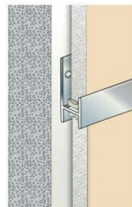
Рис. 12. Горизонтальный стык с использованием Н-образного профиля
