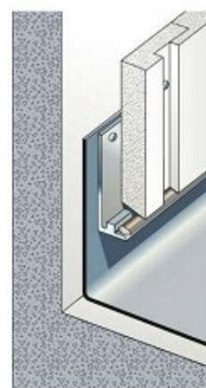
Рис.9. Край с базовым профилем во влажной зоне загнутая
